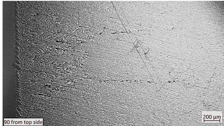
Рисунок 3.12 — Зображення з оптичного мікроскопа початку росту евтектики \text{Al}_2\text{O}_3/\text{YAG} від пласкої затравки сапфіру
