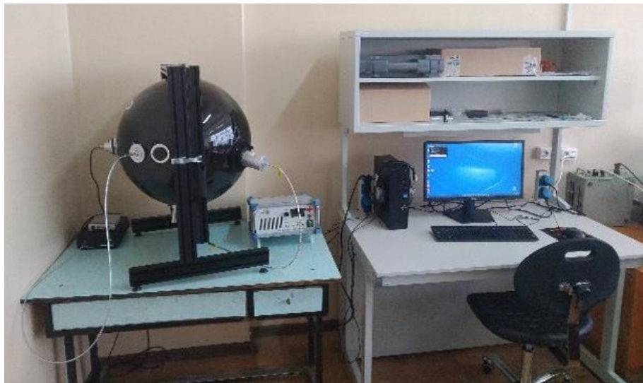
Рисунок 2.8 — Фото світлотехнічного стенду Інституту монокристалів НАН України
