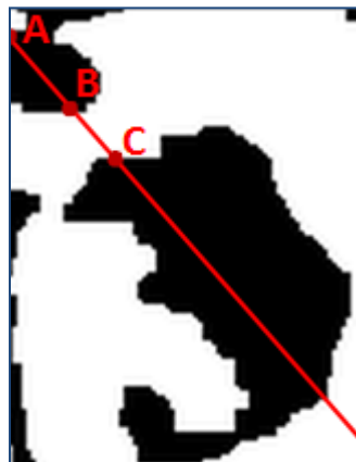
Рисунок Б.3 — Фрагмент бінаризованого зображення та сікуча лінія: відрізок АВ – чорна хорда (фаза Al_2O_3 ), ВС (фаза YAG) – біла хорда, AC – бінарний домен
