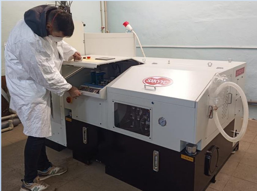
Прес ізостатичного холодного пресування KJYu150-300/300MPa (придбано в рамках проєкту Національного фонду досліджень України №2020.02/0293)
