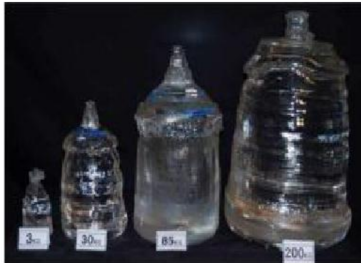
Рисунок 1.11 – Лейкосапфір, вирощений методом Вернейля.
